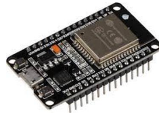
Gbr. 4 Mikrokontroler ESP32
