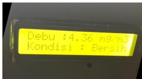
Gbr. 14 Tampilan LCD Untuk Pengukuran Kadar Debu
