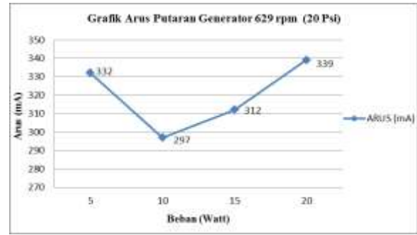
Gambar 14. Grafik Variasi Beban Terhadap Arus Generator Putaran 629 rpm
