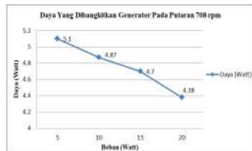
Gambar 11. Grafik Variasi Beban Terhadap Daya Generator Putaran 708 rpm
