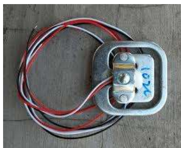
Gambar 2. Contoh Sensor Berat Loadcell
