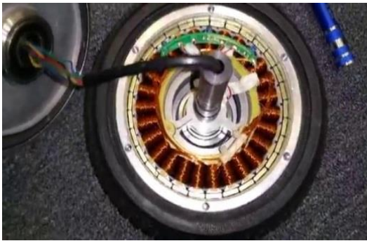
Gbr 2. Generator BLDC Hoverboard 250 Watt.
