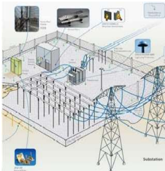
Gbr 5 Sistem Pentanahan Gardu induk
