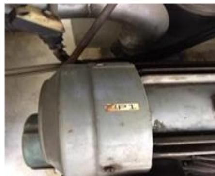
Gambar 6 Motor Induksi 3 fasa
