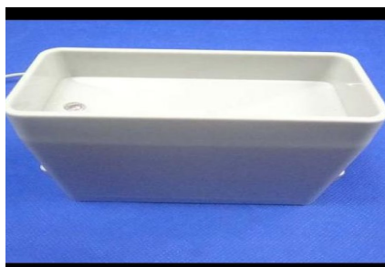
Gambar 2 Sensor Curah Hujan
