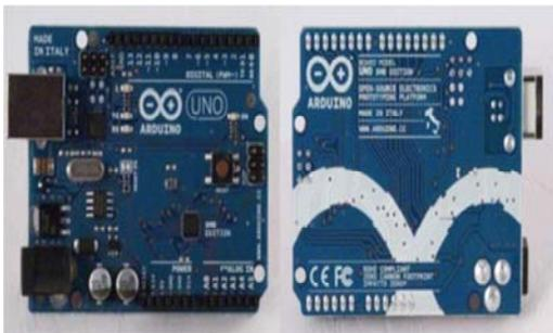
Gambar 1. Arduino Uno R3 Sisi Depan dan Belakang
