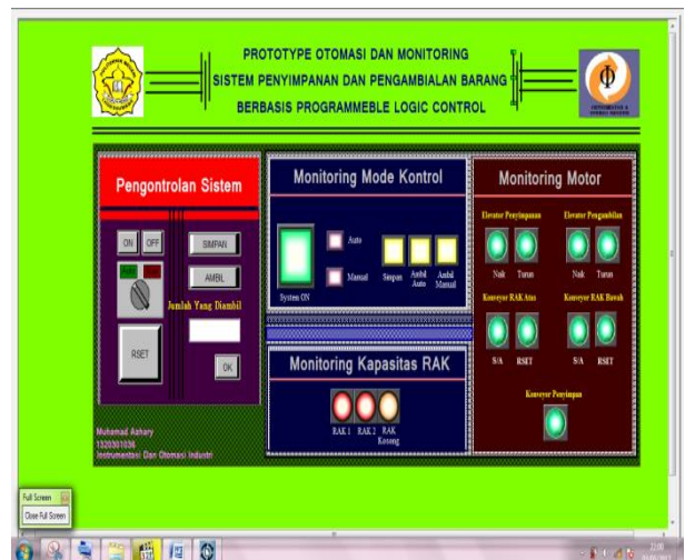
Gambar 11. Hasil Keseluruhan Perancangan Komponen Monitoring
