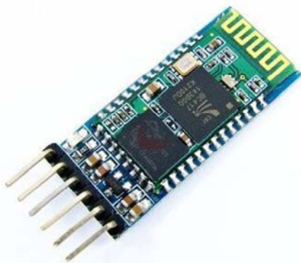
Gambar 3. Bluetooth Module HC-05
