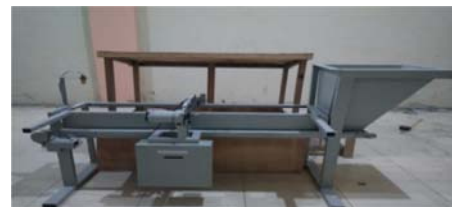
Gambar 7.. Konstruksi Sistem Pemberi Pakan Ternak Secara Otomatis
