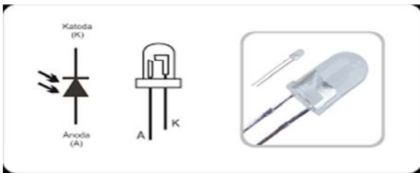
Gambar 2. Simbol dan Bentuk Fisik Sensor Photodioda
