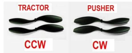
Gambar 4. *Propeller* CW dan CCW
