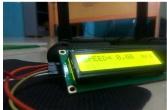
Gambar 13. Pengujian Sensor Kecepatan Angin
