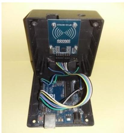
Gambar 12 Sambungan Perangkat Arduino UNO dan RFID Reader
