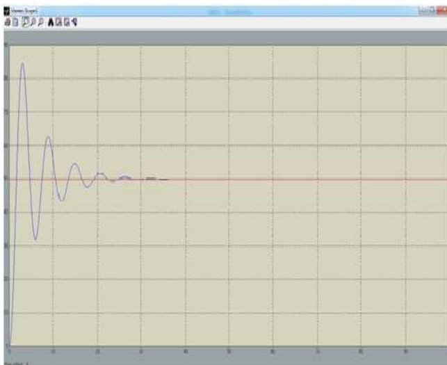
Gambar 15. Respon sistem menggunakan parameter pengendali optimasi chien, hrones dan reswick metode open loop
