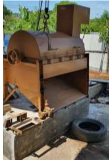
Gambar 1.3 Mesin Pengurai Sabut Kelapa (Defibring Machine)
