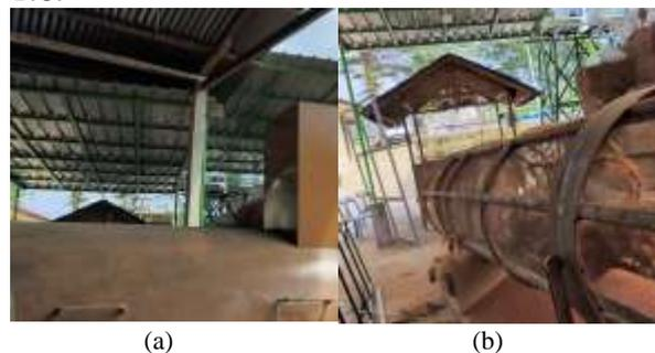
Gambar 1.6 Proses Produksi (a) Penguraian sabut kelapa dengan alat defibring machine, (b) Pemisahan cocofiber dan cocopeat dengan rotary screening machine.
