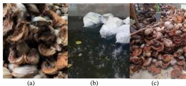
Gambar 1.5 Proses Persiapan Sabut (a) Sebelum Perendaman, (b) Pada Saat Perendaman dan (c) Setelah Perendaman
