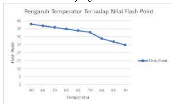
Gambar 6. Pengaruh Temperatur Terhadap Nilai Flash Point
