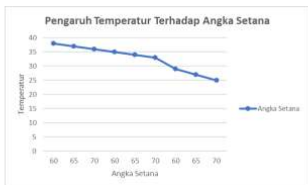
Gambar 5. Pengaruh Temperatur terhadap angka setana
