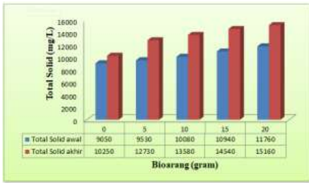
Gambar 5 Pengaruh variasi berat bioarang terhadap Total Solid (TS) pada proses anaerobik dengan perlakuan pretreatment NaOH 8%
