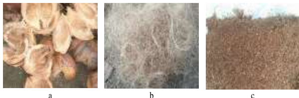
Gambar 4.2 Bahan dan Produk : a) Sabut Kelapa Sabut sebelum diurai, b) Serat sabut kelapa setelah diurai (Cocofiber), c) Serbuk sabut kelapa (Cocopeat)
