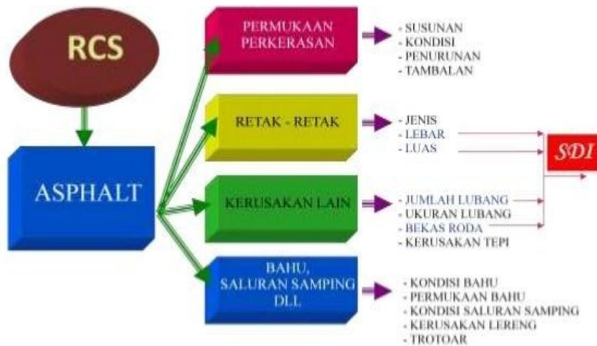
Gambar 1. Tinjauan permukaan jalan aspal
