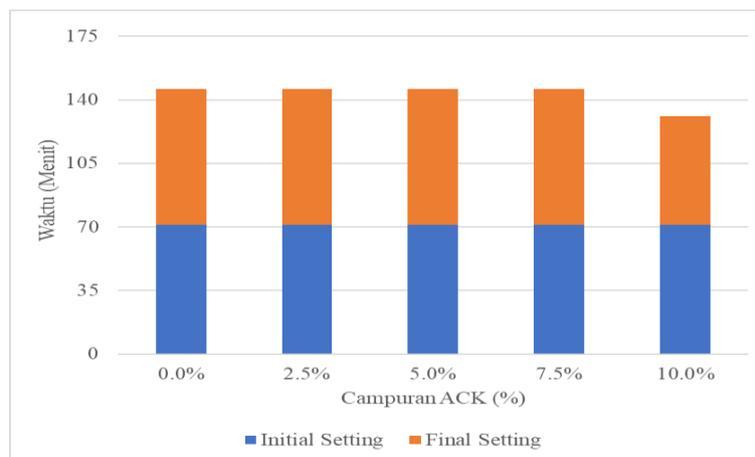
Gambar 6. *Setting time* mortar dengan FAS 0,45
