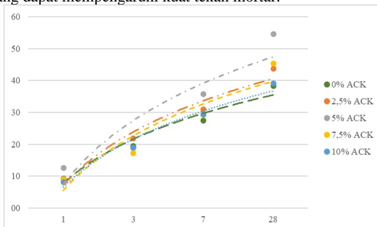
Gambar 9. Grafik hasil pengujian kuat tekan mortar dengan campuran ACK menggunakan FAS 0,5
