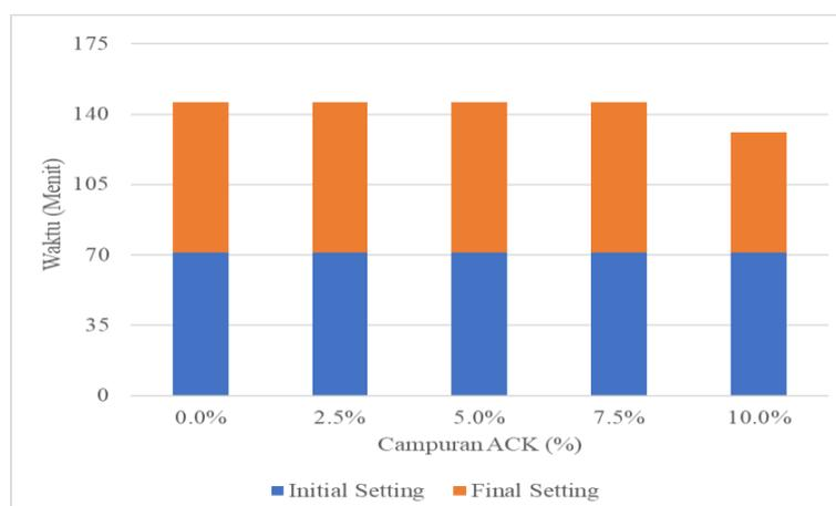
Gambar 7. *Setting time* mortar dengan FAS 0,5
