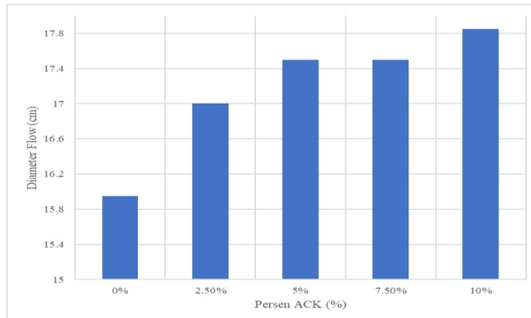
Gambar 4. *Workability* mortar dengan FAS 0,45
