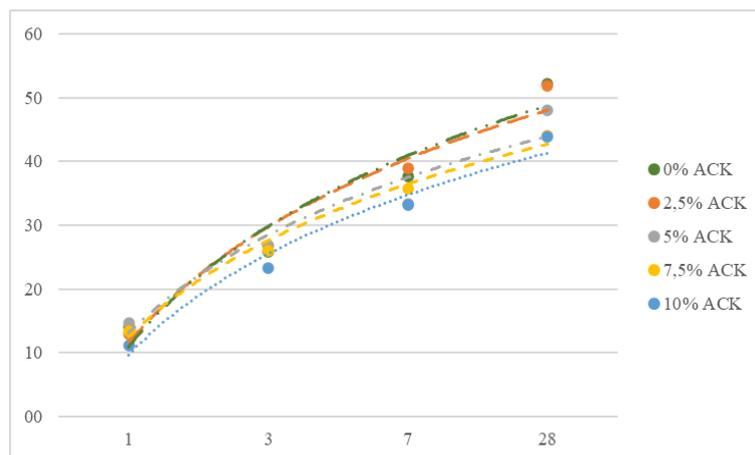
Gambar 8. Grafik hasil pengujian kuat tekan mortar dengan campuran ACK menggunakan FAS 0,45
