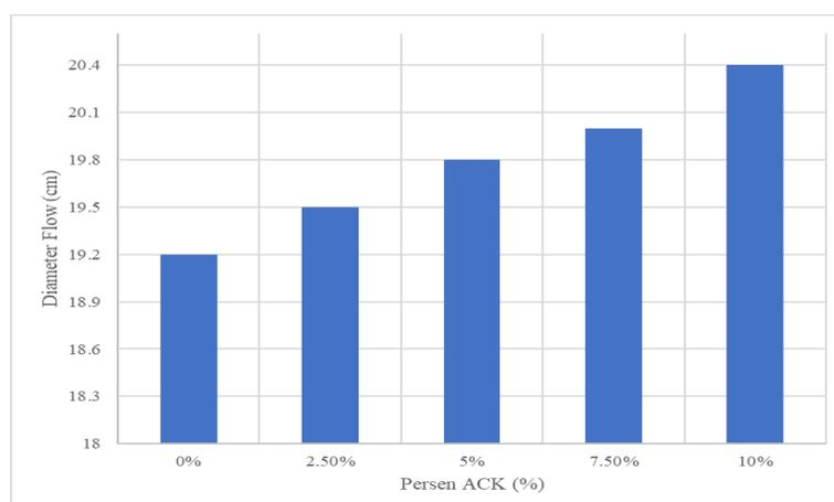
Gambar 5. *Workability* mortar dengan FAS 0,5
