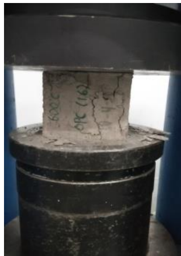
Gambar 3. Pengujian kuat tekan
