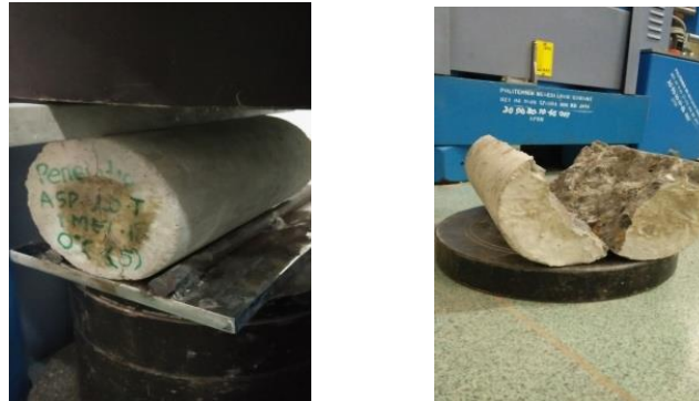
Gambar 4. Pengujian kuat tarik belah
