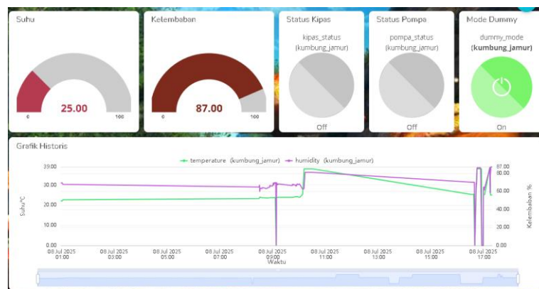
Gambar 8. Pengujian Tampilan Ubidots
