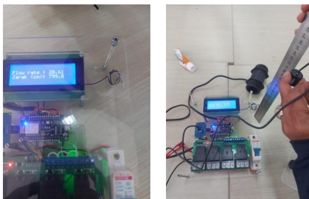
Gambar 7. Pengujian Flow Sensor dan Ultrasonic Sensor
