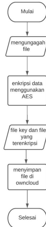
Gambar 2 Flowchart tahapan sistem
