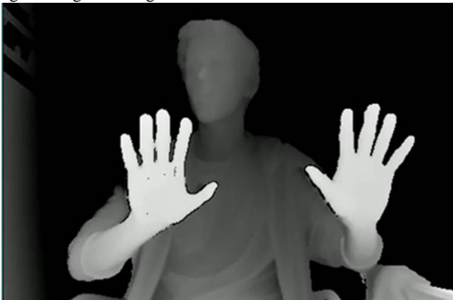
Gambar 3. Hasil Depth Image dari Kamera kinect
