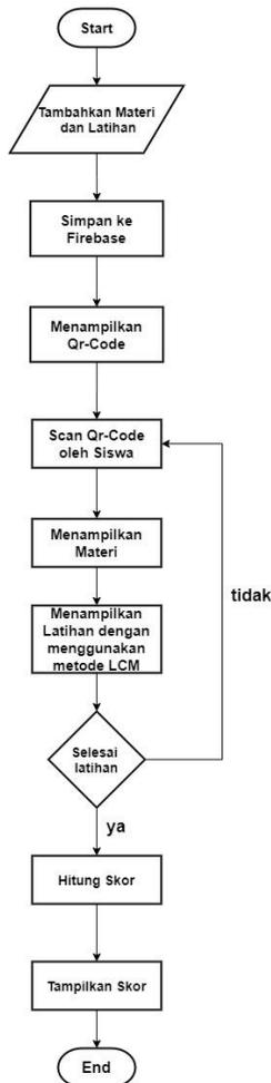
Gambar 5 Flowchart pembuatan sistem
