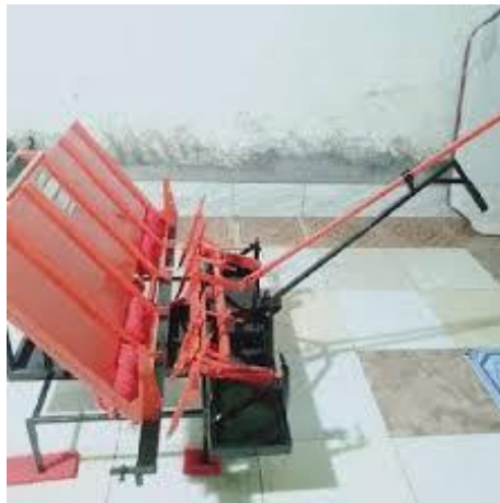
Gambar 2. Alat tanam padi sistem penggerak mekanik
