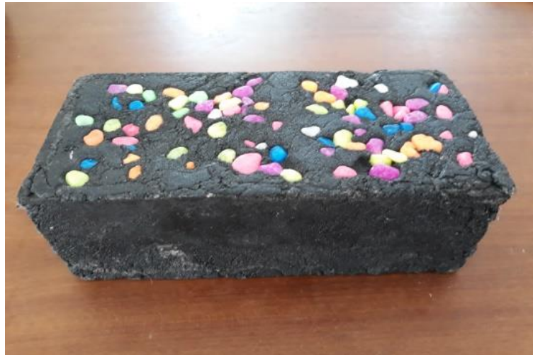
Gambar 6. Paving block dari sampah plastik
