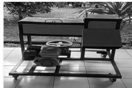
Gambar 4. Mesin pencacah limbah kalamud yang dibuat.
