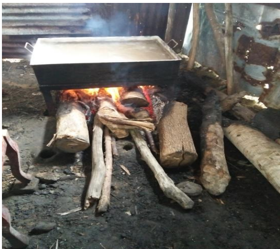
Gambar 1. Rekristalisasi Garam peralatan lama
