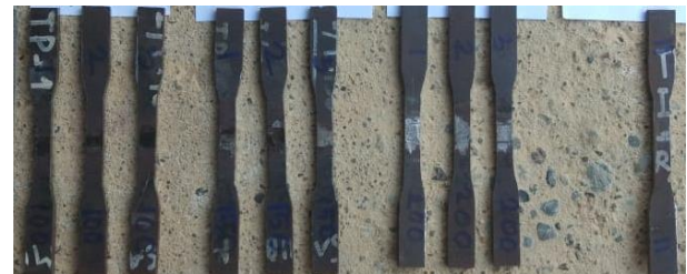
Gambar 5 Spesimen uji tarik arus 80 A, 90 A, 100 A, dan spesimen tanpa pengelasan.
