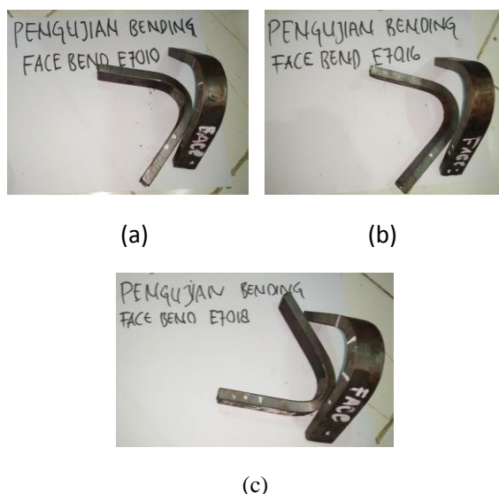
Gambar 10. Hasil uji face bend pengelasan menggunakan: (a) elektroda E7010-P1, (b) elektroda E7016, (c) elektroda E7018
