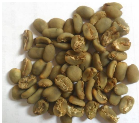
Gambar 10. Biji kopi setelah di keringkan menggunakan kecepatan udara 4,03 m/s dengan nilai kadar air 5 %
