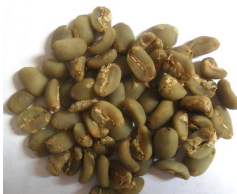
Gambar 9. Biji kopi setelah di keringkan menggunakan kecepatan udara 3,75 m/s dengan nilai kadar air 5 %
