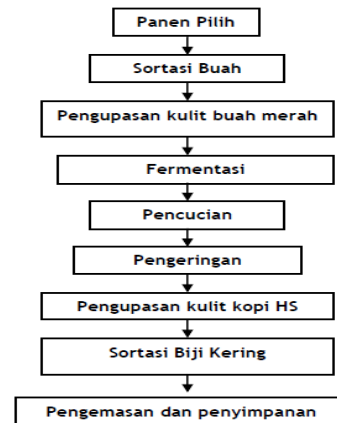
Gambar 2. Tahapan proses kopi secara basah ( Fully washed ) Sumber: Suswono (2012)
