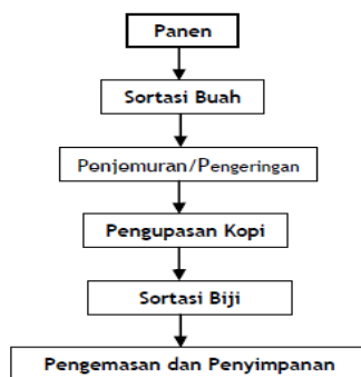
Gambar 1. Tahapan proses kopi secara kering ( Dry Process ) Sumber: Suswono (2012)
