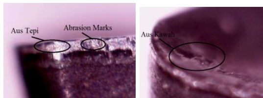
Gambar 17. Bentuk tumbuhnya lapisan metal (BUE) pada pemotongan V_c 250 m/menit
