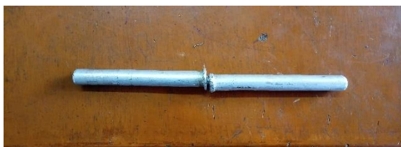
Gambar 4.1 Benda uji Tarik friction welding yang tidak center pada penyambungannya Sumber : (Laboratorium Uji Tarik)
