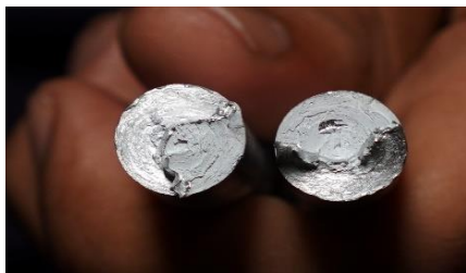
Gambar 4.3 Patahan spesimen uji pada 1500 Rpm
