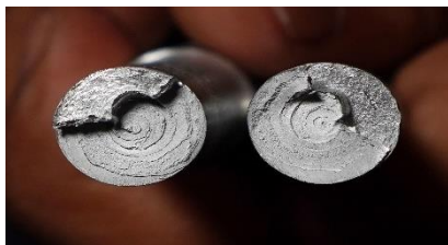
Gambar 4.2 Patahan spesimen uji pada 2500 Rpm
