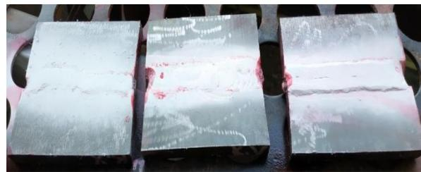
Gambar 4.2 Hasil Pengujian *Penetrant*
