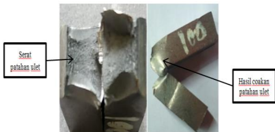
Gambar 7. Hasil Patahan Impak Pada arus pengelasan 100 Ampere
