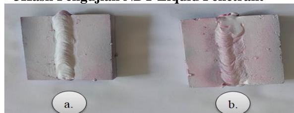
**Gambar 6.** (a) kampuh *double bevel* dan (b) kampuh *double v groove*
