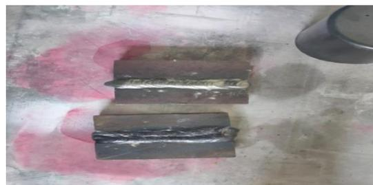
**Gambar 5.** Hasil pengelasan kampuh *double bevel* dan *double V groove*
