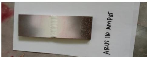
Gambar 3. pengujian NDT Liquid penetran
