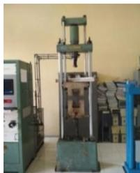
Gambar 2 Mesin uji tarik
