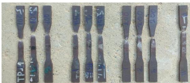
Gambar 10. Hasil uji tarik spesimen interpas 100°C, 150°C, 200°C, dan raw material
