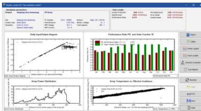
Gambar 3. Hasil Simulasi PLTS-CS di Taman Simpang Lima menggunakan Perangkat Lunak PV Syst dimana (a) menggunakan modul surya JA Solar Tipe JA SOLAR 250 JAP6 (DG) dan (b) menggunakan Canadian Solar tipe CS1V – 250 MS.
