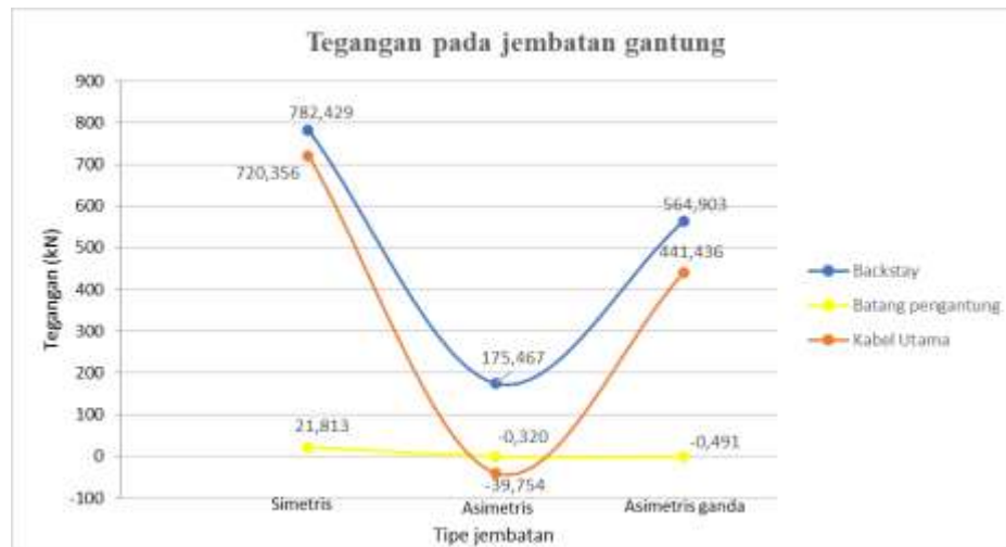
Gambar 3. Grafik perbandingan nilai tegangan pada jembatan
